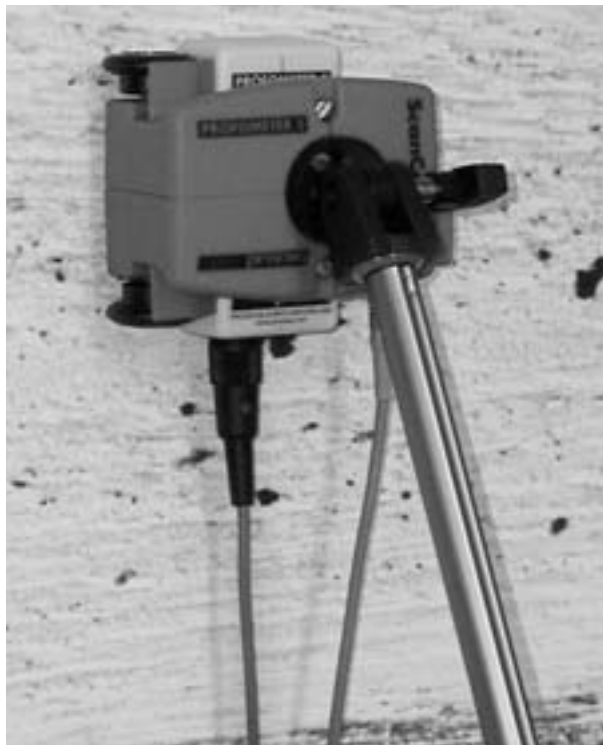
PARTICOLARE DELLA SONDA SCANCAR CON ASTA TELESCOPICA
